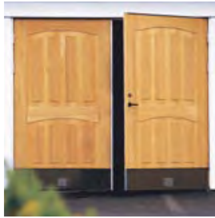
Slagporten har två dörrar som svänger utåt på gångjärn. Ena dörren "låses" med spanjolett, den andra fungerar som en gångdörr.
